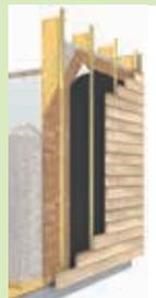
Dans les murs extérieurs de la construction à ossature bois, il est demandé de protéger la structure ainsi que l'isolant entre ossatures
